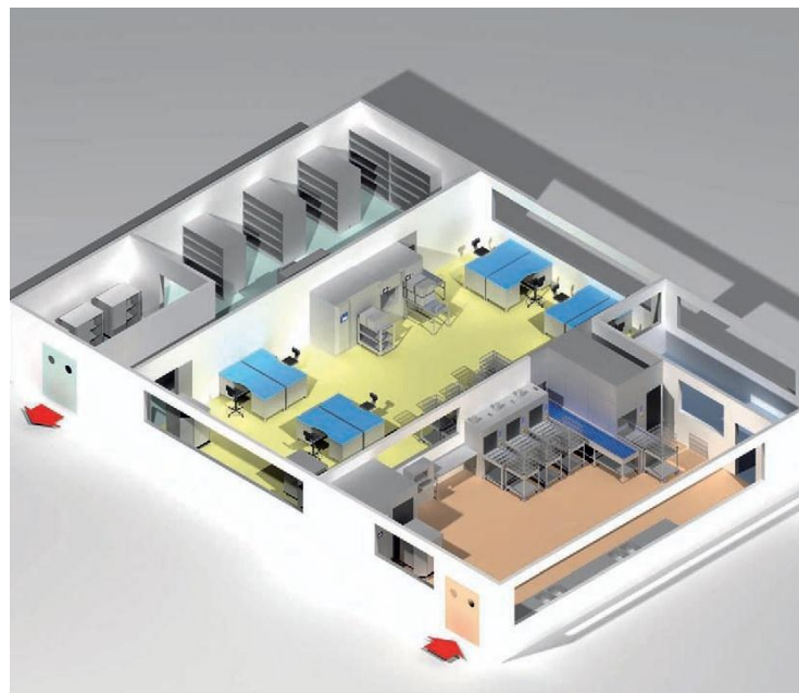
Gambar 3.2.6 - Contoh Instalasi Sterilisasi Sentral di Rumah Sakit dengan otoklaf 2 pintu
